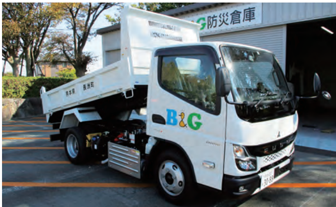
長洲町に配備されたスライドダンプ
