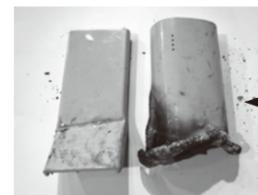
破碎処理中に発火したモバイルバッテリーのリチウムイオン電池
